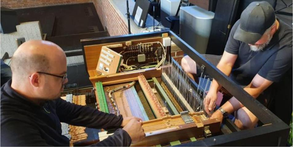
unteren Manual mitgespielt werden können. Auf Grund der begrenzten Registerzahl der Orgel in der Erlöserkirche benutzt man diese Koppel häufig, um bestimmte Registermischungen zu erzeugen. Diese Koppel wird elektrifiziert, da sie extrem schwergängig war. Damit geht als zusätzlicher Effekt einher, dass man zukünftig zusätzlich auch eine sogenannte Sub- und Superkoppel zur Verfügung hat, das bedeutet, die Klänge werden nach oben oder unten oktaviert. Man gewinnt also mehr Möglichkeiten.
