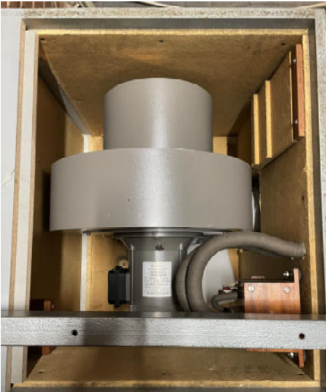
Ein neuer Motor (links) und eine „Winddrossel“ (rechts) finden ihren Platz in der Orgel.
