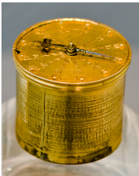
Die Henlein-Taschenuhr, entwickelt um 1510 vom Nürnberger Uhrmacher Peter Henlein, gilt als eine der ersten tragbaren Uhren der Welt. Ihr Federantrieb machte sie unabhängig von einem festen Standort. Die Uhr hatte eine Laufzeit von etwa 40 Stunden und markierte den Beginn der Entwicklung moderner Taschenuhren.
